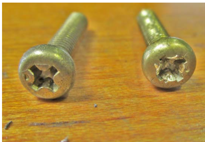
左側が正常なネジ頭。右側がネジ頭がつぶれた状態
