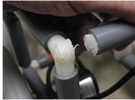
図 2 継ぎ目で割れてしまった部品
