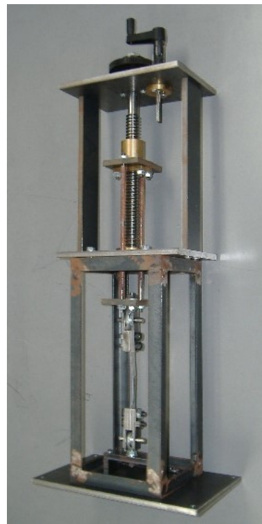
図1 簡易引張り負荷装置(過年度の作品) 上端のハンドルを回して雄ネジを回転させて雄ネジと噛み合った雌ネジを上昇させ、下側にある試験片を上方へ引っ張る。人力で1000N出せる。(だいぶ錆びてきていた。)
