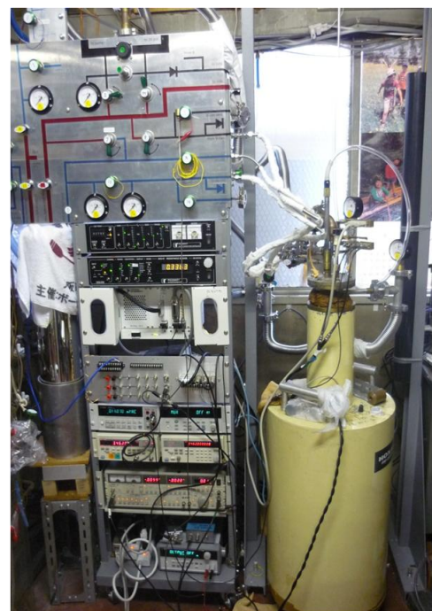
図 2. 製作した 1K-pot 付き冷凍機
