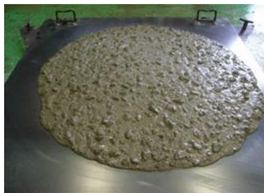
写真2 高流動コンクリート
