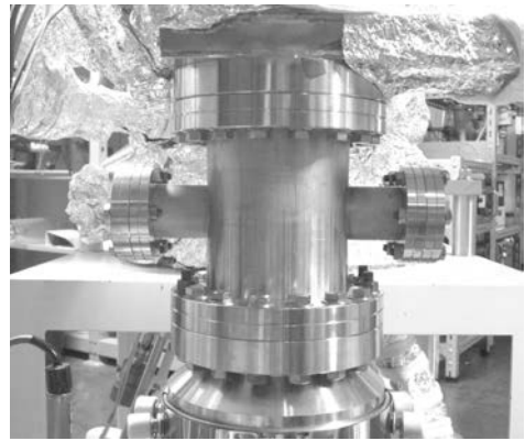
図3 引き抜き管を使った真空配管
