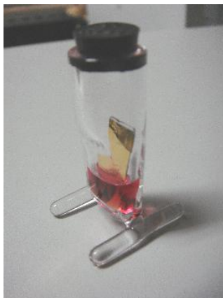
図2. 色素分子単層膜形成用基板浸漬セル 中に浸漬させてある金基板の大きさは 10mm×20mm
