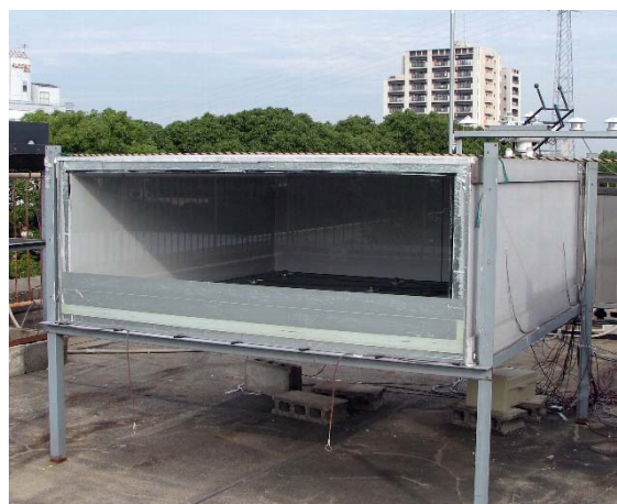
写真 4 模型時実験室による照度分布測定
