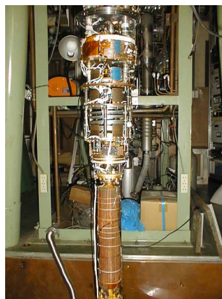
図 4. 希釈冷凍機(上部)と核断熱消磁冷凍機(下部、銅のブロック部分)
