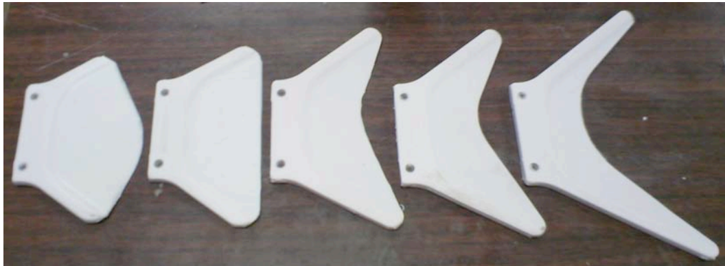
図3 実験に使用したシリコンゴム製の尾びれ（左から Type1,2,3,4,5）
