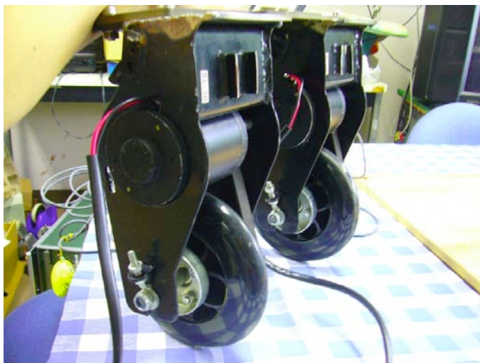
写真2 溶接した駆動部
